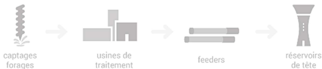
Figure 36 : production d'eau potable (source : Eau du Morbihan)
